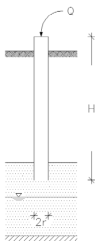
Abb. 2: Versuchsanordnung Open-End-Test und Bestimmungsgleichung
