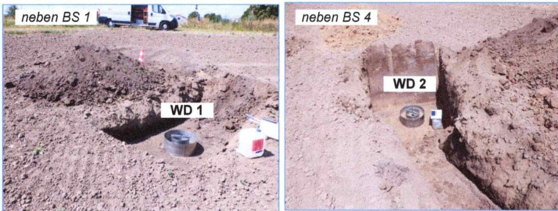
Gemäß ATV A 138, Planung, Bau und Betrieb von Anlagen zur Versickerung von Niederschlagswasser liegt der entwässerungstechnisch relevante Versickerungsbereich etwa in einem  $k_f$ -Bereich von  $1 \times 10^{-3}$  und  $1 \times 10^{-6}$  m/s.
